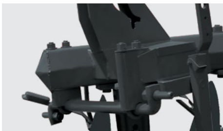
Engate hidráulico, Cat. I e II. Hitch Cat. I e II. Enganche hidráulico Cat. I y II.
